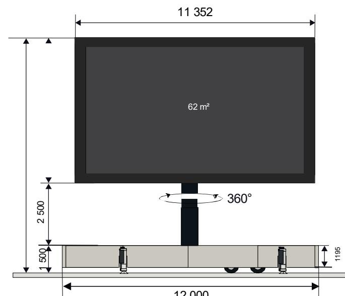
L'écran est monté sur un mât hydraulique pivotant (360°) positionnant le bas de l'image entre 1,5 et 4 m du sol.
